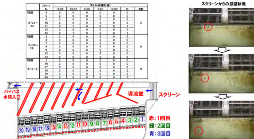
図- 36 スモルトの行動調査結果（ドラムスクリーンの忌避状況）
