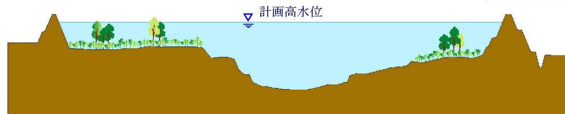
洪水流下の支障となる樹木が繁殖すると、河積が小さくなり水位が上昇する。
