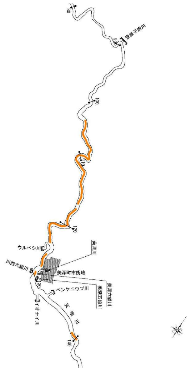
図2-8-2 河道の掘削を実施する区間 2/3
