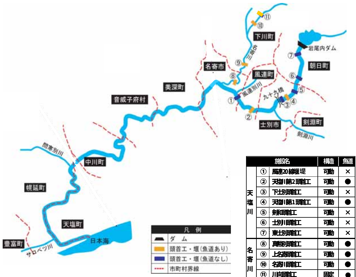
図 4-3-3 魚類等の移動経路の現状
