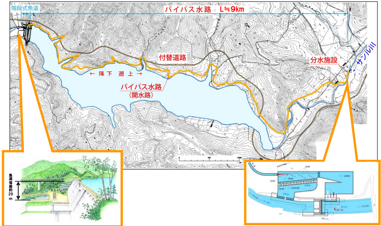
図-18 サンプルダム魚道の概要
