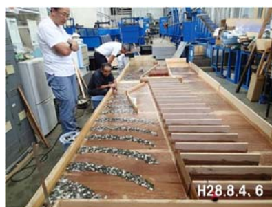
[本川との接続箇所] 施設内流況改善模型実験
