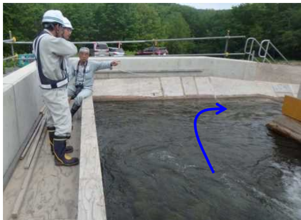
(6/11試験階段式魚道) スモルト降下状況確認
