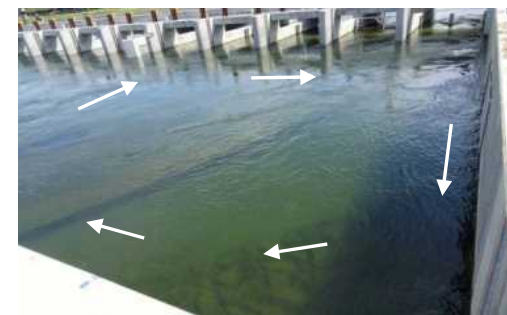
施設内の流況状況確認写真 (27m 3 /s)
