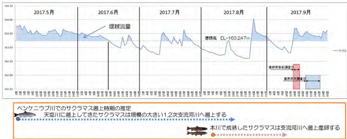
図- 15 ベンケニウプ川取水施設天端高以上の河川水位状況と親魚遡上状況
