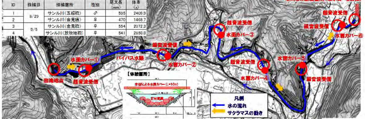
図 - 34 バイパス水路のサクラマス遡上調査平面図
