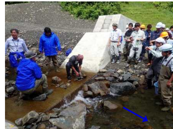
アラキの川 (No6複断面床固工) 石組みによる天端流況改善の実験
