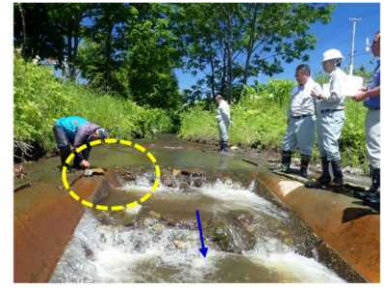
側壁天端石組みによる 遡上経路改善状況の実験
