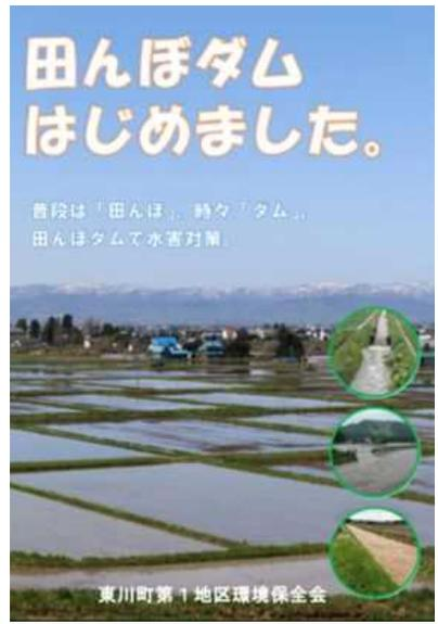
田んぼの雨水貯留機能を活用した流出抑制対策（流域全自治体）
