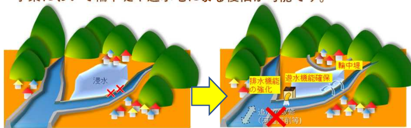
低い堤防が越水・決壊し浸水
