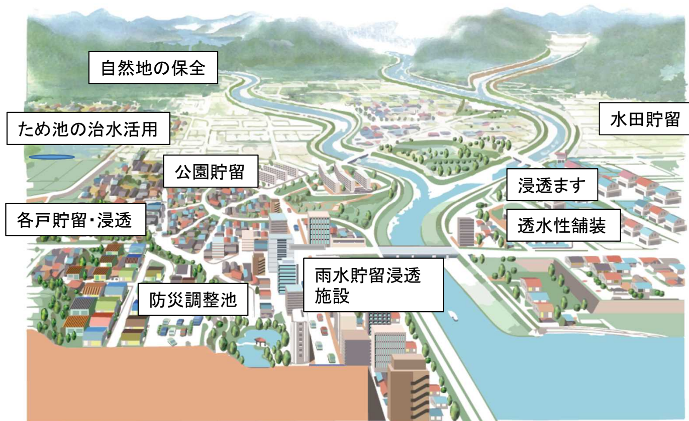
河川への流出抑制対策の例
