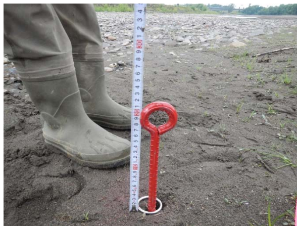
KP160.1(左岸側1つ目)のリング設置状況(H29.7.4)
