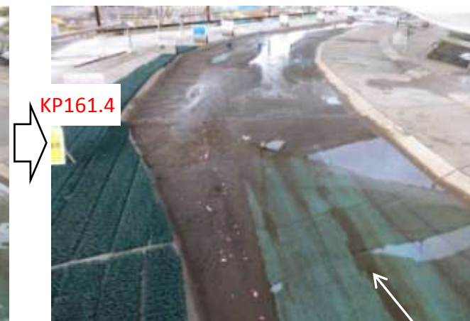
⑨通水6時間後 Q=23.0\text{m}^3/\text{s}
