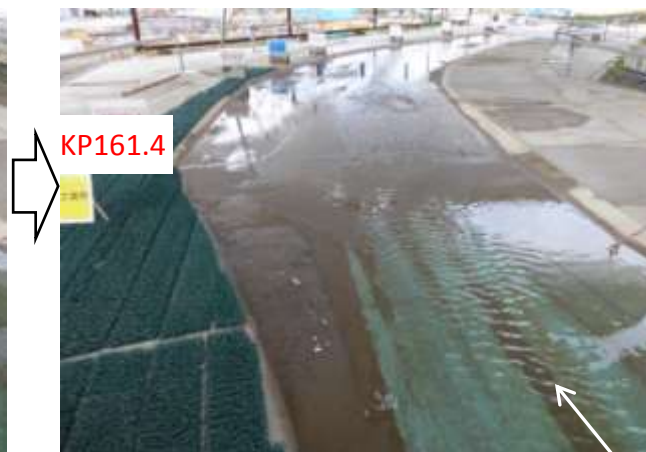
⑧通水5時間後 Q=234.0\text{m}^3/\text{s}
