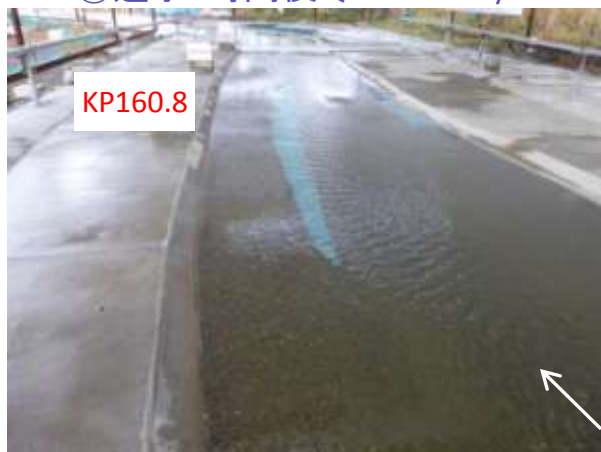
⑦通水4時間後 Q=312.7\text{m}^3/\text{s}
