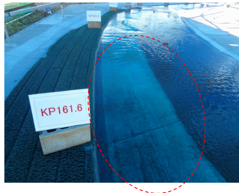
流砂が縦断的に連なって流れている状況
