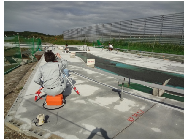
○水位計測(ポイントゲージ)
