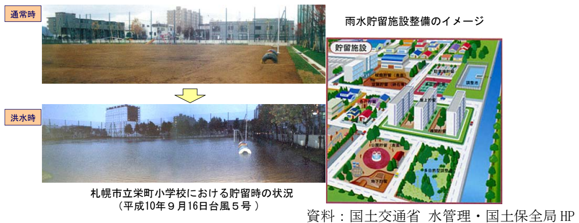
図 4.2.15 雨水貯留施設のイメージ
