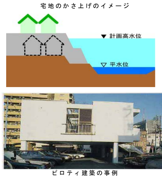
図 4.2.26 宅地かさ上げ、ピロティ建築等のイメージ
