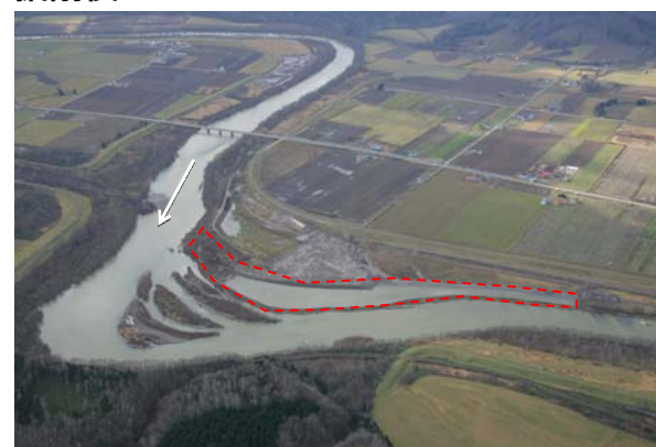
河道掘削の例（天塩川KP120付近（美深町））
