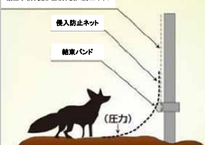
地中埋設型の形式において、侵入防止ネットにより侵入防止機能を持たせた構造形式を採用
