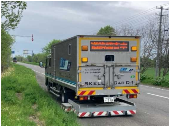
路面下空洞調査状況
