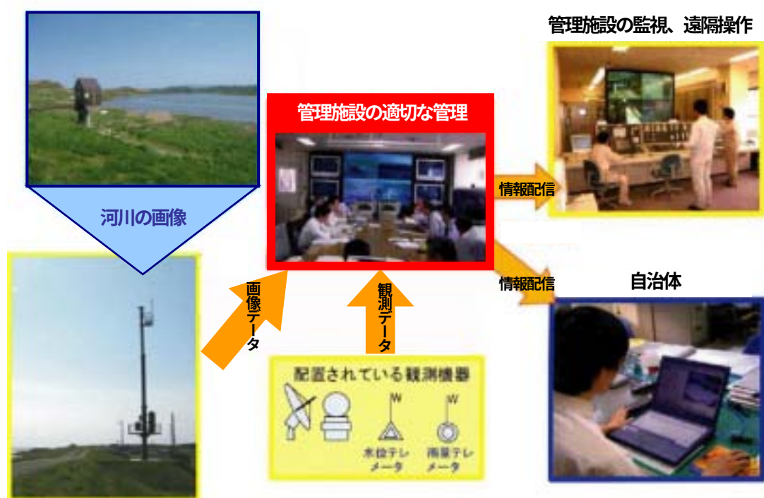
図 2-5 光ファイバー網による河川情報の収集・伝達のイメージ図
