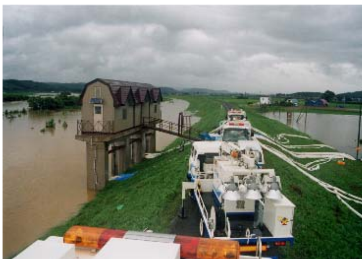
図 2-3 内水排水の状況
