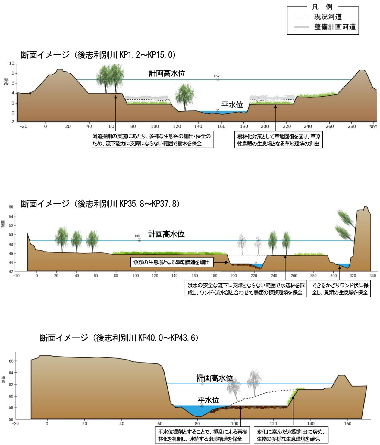
図 2-1 河道の掘削のイメージ図
