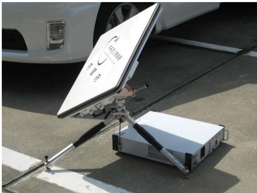
衛星通信装置 (可搬型)
