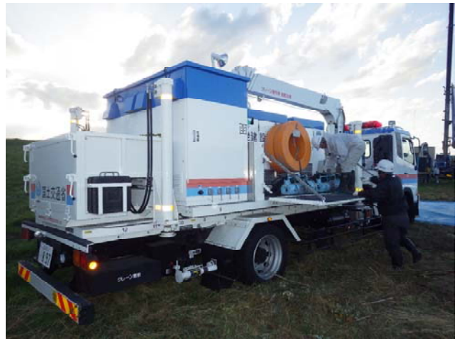
排水ポンプ車
