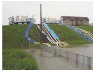
排水ポンプ車
