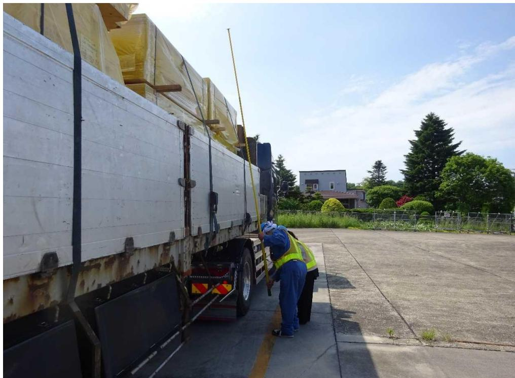
積載貨物を含めた車両の長さ・幅・高さを計測し、許可値を超えていないか確認します。
