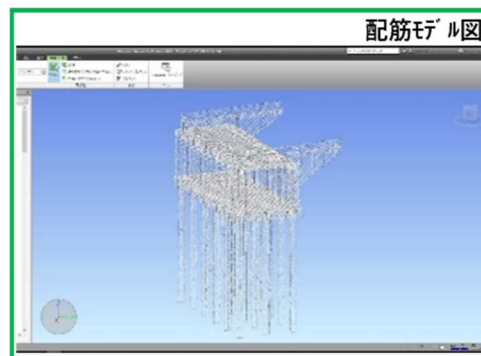
BIM/CIMの活用による鉄筋組立順序の確認
