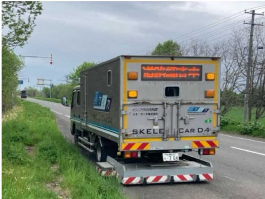
路面下空洞調査状況
