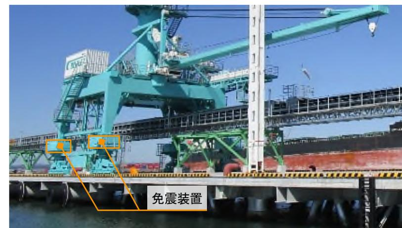
大規模地震発生時に穀物の拠点港として、ターミナル機能の速やかな復旧・再開を図るため、免震装置を装備したアンローダーを採用
