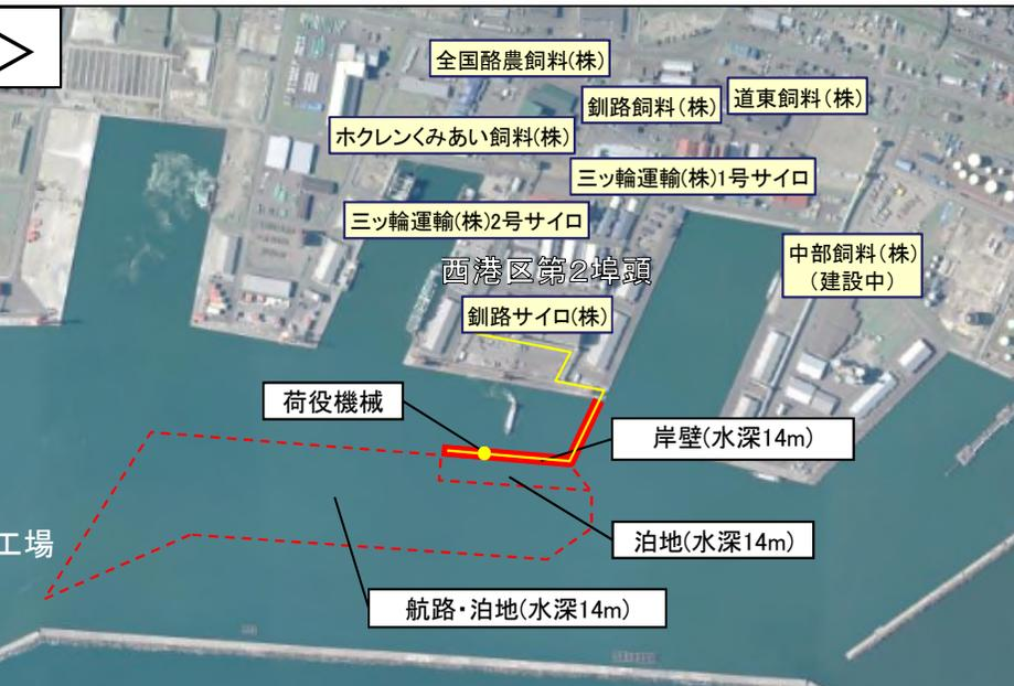
【整備施設】岸壁(水深14m)、泊地(水深14m)、航路・泊地(水深14m)、荷役機械(補助)
