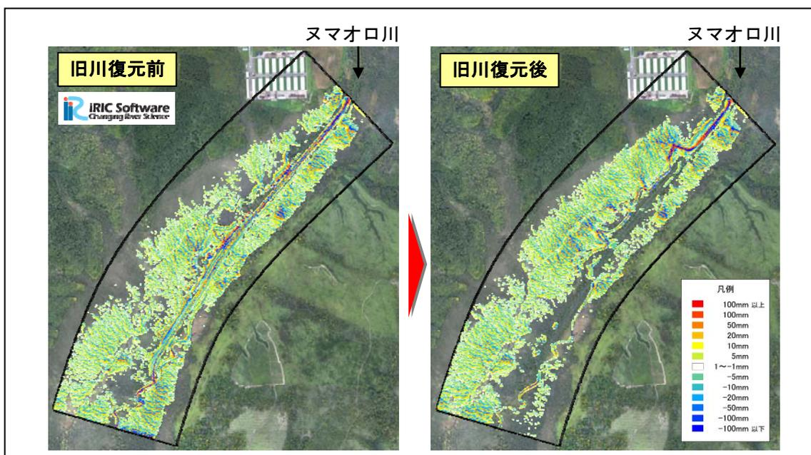
図 3-14 氾濫解析による堆積厚分布図の例
