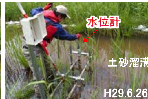
水位計点検・データ回収
