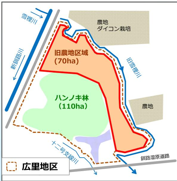
原因：旧雪裡川の分断、農地造成による水位低下
