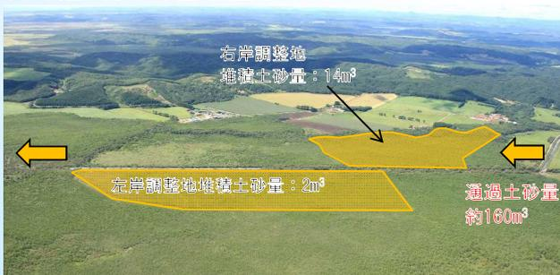
図2 通過土砂量と堆積土砂量
