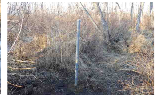
地下水位計の設置状況 （幌呂No. 18）
