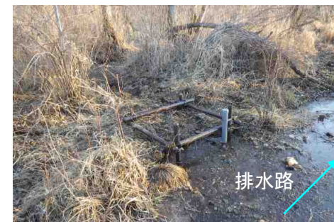
地下水位計の設置状況 （幌呂排水路No. 3）
