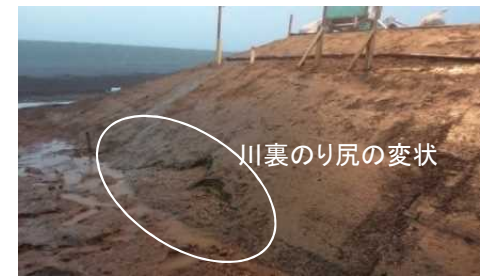
現地堤防実験の様子（降雨による川裏のり尻の変状）
