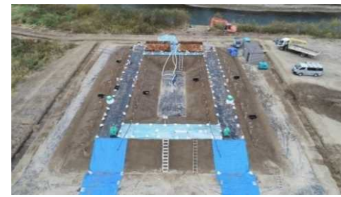
現地堤防実験の様子（降雨による川裏のり尻の変状）
