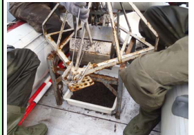
底生動物調査で 使用した採泥器
