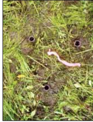
土砂トラップ設置
