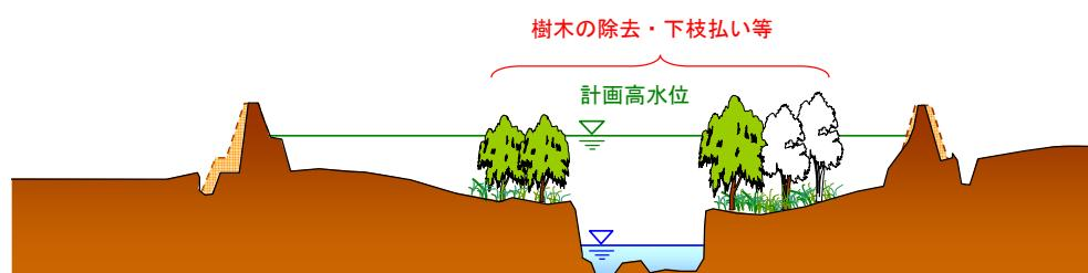
図 2-1 堤防整備及び樹木除去等による流下能力確保のイメージ図
