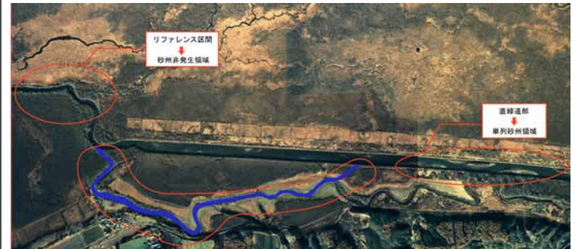
衛星写真による現況河道の河床形態比較（参考図）
