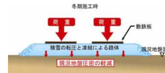
図 4-11 現況地盤圧密の軽減対策例
