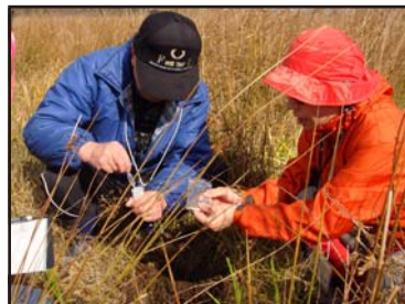
掘った土砂でジピリジル試験
