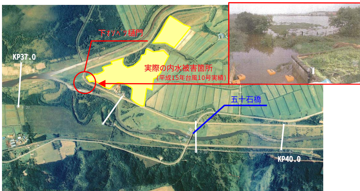
図 2-33 上;水防活動の状況(排水ポンプ車稼動状況、釧路川下オソベツ樋門;KP37.6 付近) 下;内水被害が想定される下オソベツ樋門付近の概況 (平成 8 年航空写真より)
