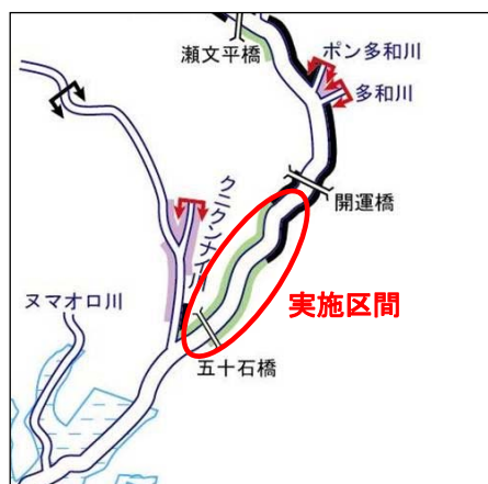
堤防整備及び樹木除去等による流下能力確保のイメージ図
