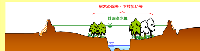
堤防整備及び樹木除去等による流下能力確保のイメージ図
