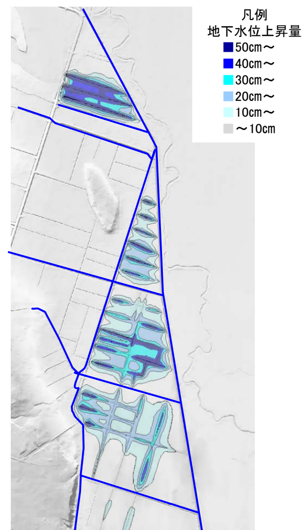
未利用排水路埋め戻しによる 地下水上昇量(予測)
