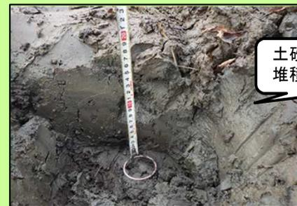
土砂トラップの上に堆積した厚さを測定
