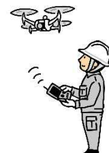
ドローンによる、 外壁タイルの赤外線調査
