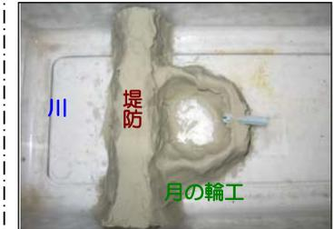
堤防に漏水するような水みちを作ります(ストローで穴をあけます)。
