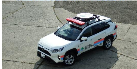
移動型衛星通信設備 Car-SAT映像配信訓練
