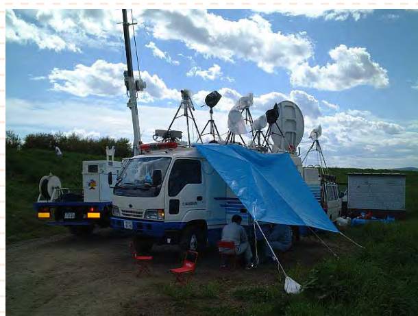
衛星通信移動局に設置したFPU 受信アンテナ（左）、局内での受信状況（右）
