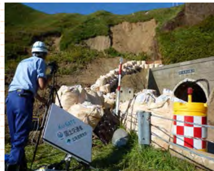
Ku-SAT II による画像伝送 平成 26 年 8 月土砂崩監視 (礼文島)
