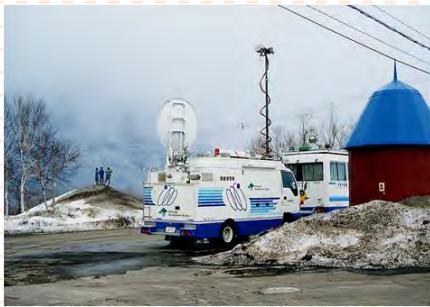
衛星通信車による画像伝送 平成 12 年 3 月有珠山噴火 (壮瞥町)
