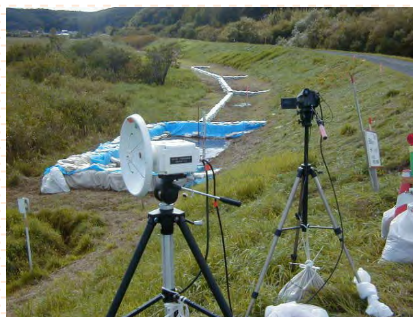
平成13年9月台風15号 網走湖住吉築堤 築堤盤膨れ状態監視のための画像伝送
