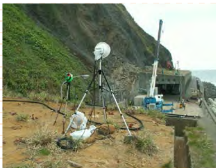
FPU による画像伝送 平成 20 年 5 月土砂崩れ斜面監視 (国道 231 号増毛町岩尾)
