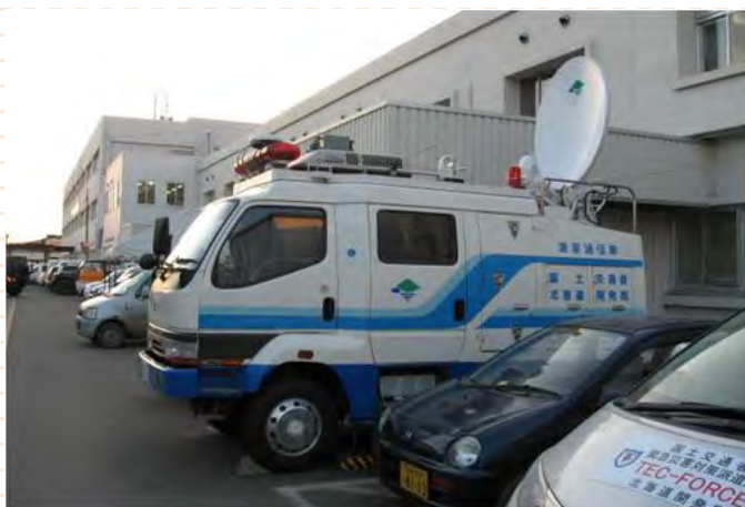
衛星通信車による電話回線
