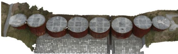
図-12 覚生川2号砂防堰堤:3次元モデル
