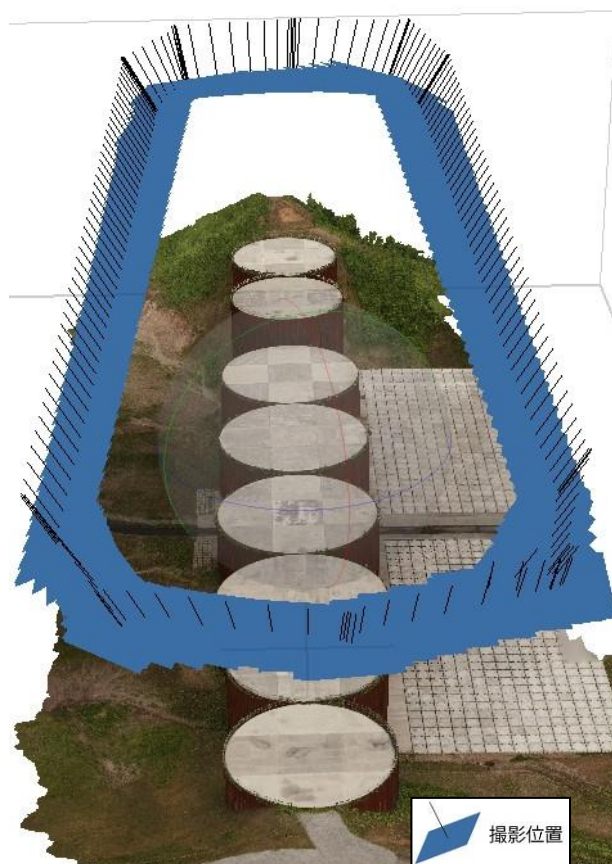
図-2 UAVによる撮影方法のイメージと3次元モデル
